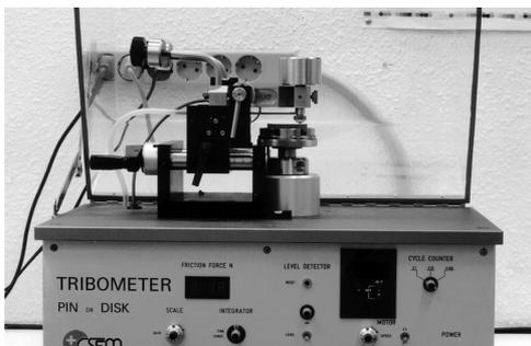
Figura 1 Tribómetro Pin-on-disk
