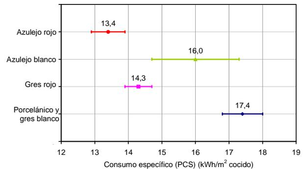
**Figura 3. Consumo específico en la etapa de cocción (kWh/m² cocido), en régimen estacionario de funcionamiento.**
