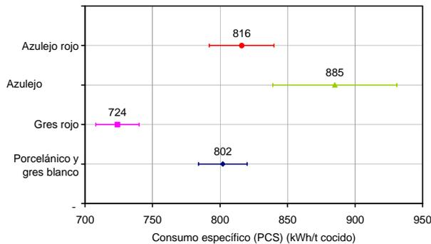
**Figura 2. Consumo específico en la etapa de cocción (kWh/t cocido), en régimen estacionario de funcionamiento**
