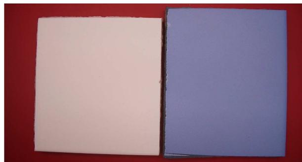
Figura 4 Piezas previa (izquierda) y posteriormente (derecha) a la aplicación de un color soluble.
