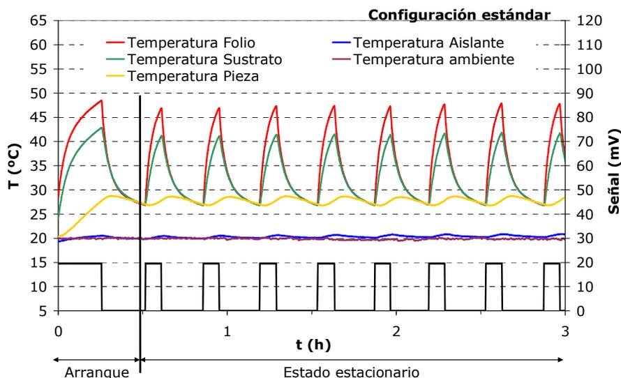
**Figura 4. Distribución de temperaturas durante un ensayo típico.**
