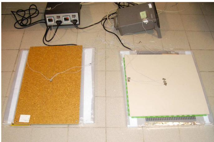
**Figura 5. Foto general del montaje mostrando la diferencia de dimensiones entre la pieza de corcho y del sistema CIVIS' TERMIA®.**
