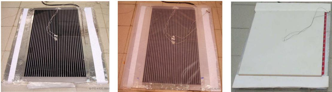
**Figura 3. Fotos mostrando la colocación de los termopares de medida sobre el folio (izquierda), el sustrato de polietileno (centro) y la pieza (derecha).**
