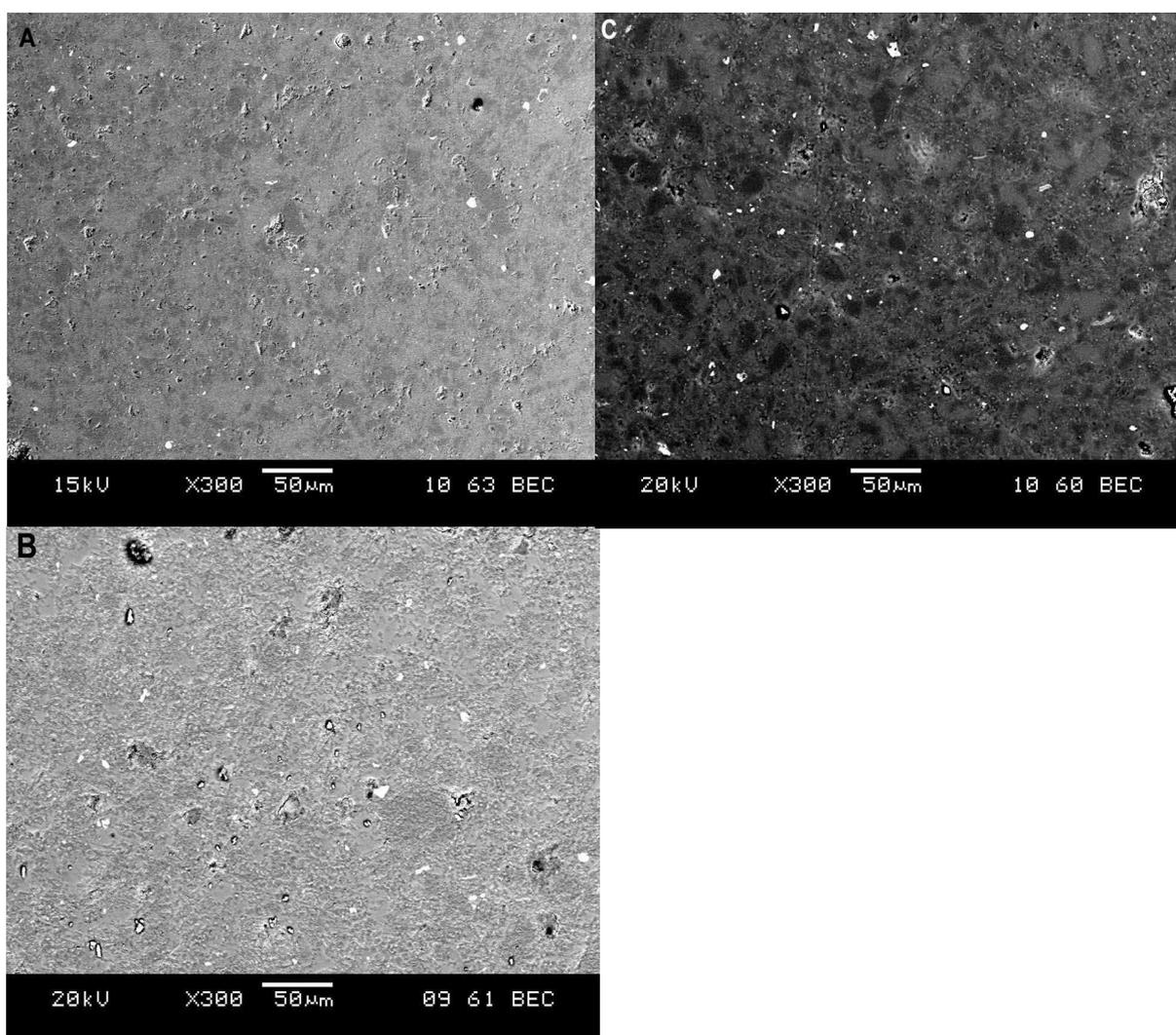
Figura 4: Micrografías de las muestras a)P100 b)P101 c)P102 sobre muestras con una absorción de agua inferior a 0,5% obtenidas mediante electrones retrodispersados.
