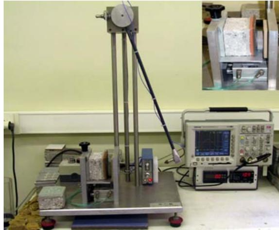
Figura 9. Vista general del dispositivo empleado para la determinación de la resistencia al impacto.
