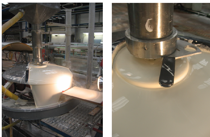
Figura 7. Prototipo instalado en la línea de esmaltado industrial (izquierda) y detalle del sistema de cambio rápido de boquilla (derecha).
