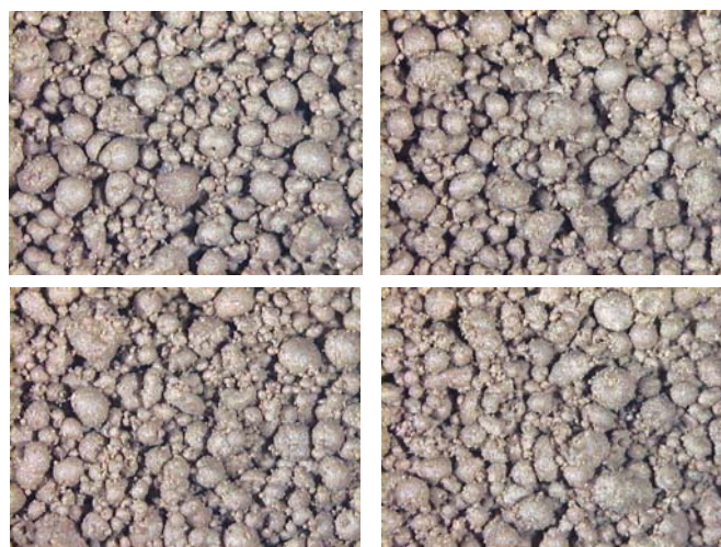
Figura 7. Fotografías realizadas con el microscopio estereoscópico de las muestras de la composición de azulejo rojo. De izquierda a derecha y de arriba abajo: camión, entrada del silo, salida del silo y alimentación de la prensa.
