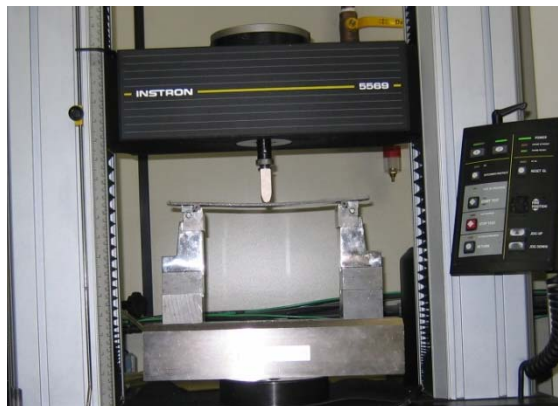
Figure 3: Configuração do ensaio utilizado no programa experimental para medida da flexibilidade.
