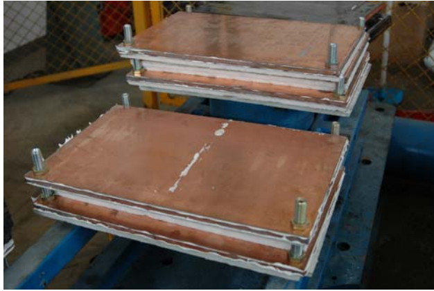
Fig.6 Colectores ya ensamblados.
