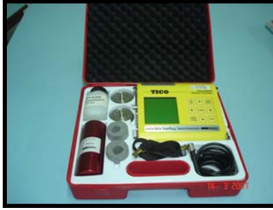
Figura 4 – Equipo portátil de ensayo no destructivo por ultrasonidos PUNDIT
