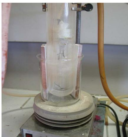
**Figura 3.** Celda de degradación fotocatalítica.
